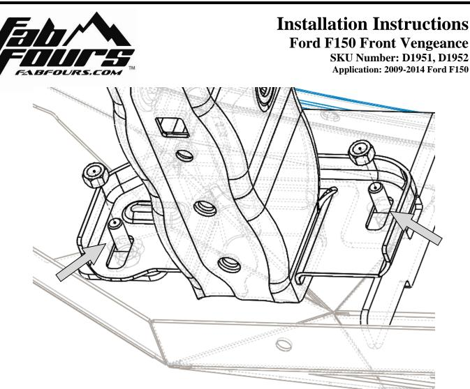
Figure 5 – FRAME FASTENER INSALLATION LOCATION
