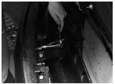
Figure 1 - HOOD LATCH BRACKET FASTENER LOCATION
