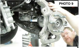
LOOSEN LOWER BALL JOINT
