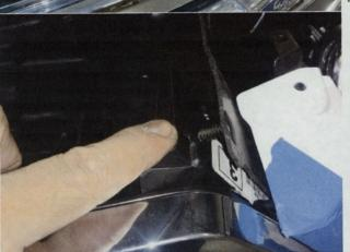
STEP 2- REMOVE SIDE PLASTIC PUSH ON TABS THAT HOLD PLASTIC GUARD TO GRILL
